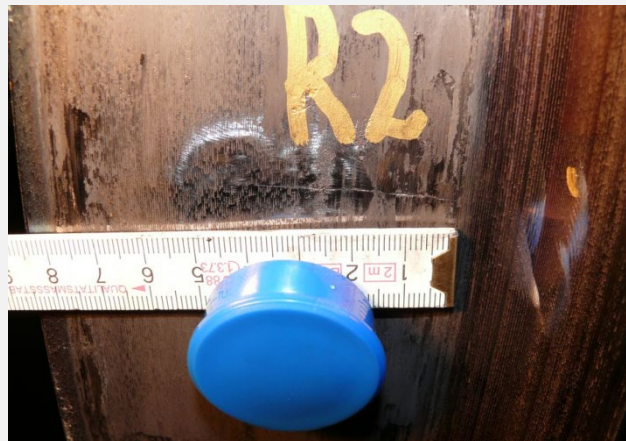
Querriss durch Magnetpulver- prüfung festgestellt [EN 15313, C.2.6 ]
